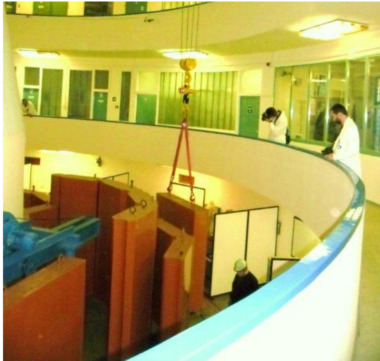
1.3-2. kép: A BME NTI Oktatóreaktor kördaru erőmérési próbájának hatósági ellenőrzése
